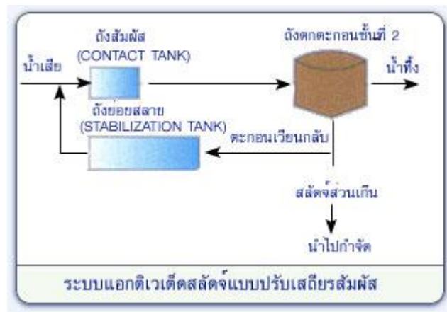
ภาพ 3 ระบบบำบัดน้ำเสียแบบตะกอนเร่งแบบปรับเสถียรสั้มผัส
